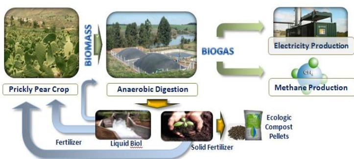
La Opuntia como biomasa, es sometida a un proceso de digestión anaerobia. Con el Biogás generado se puede:
